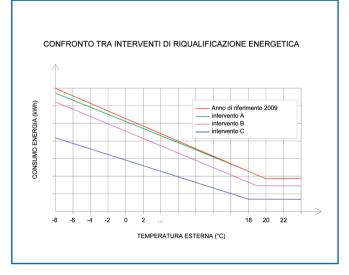
L'intervento a) non apporta vantaggi apprezzabili in termini di consumi per il riscaldamento e non migliora la richiesta energetica per la produzione di acqua calda sanitaria rispetto alla situazione di partenza.
